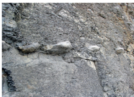
Abb. 6: Mergelknollen im Tonschiefer der Steilküste von Whitby (England) wurden zum Brennen von Romanzement gesammelt.
