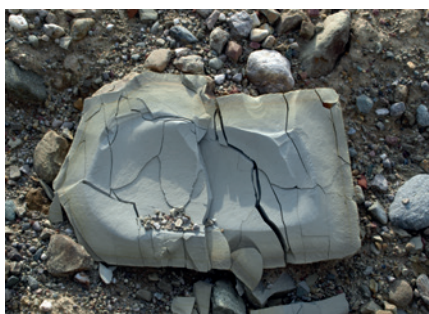
Abb. 7: Charakteristischer Mergelstein in einem historischen Romanzementsteinbruch bei Kufstein (Österreich).
