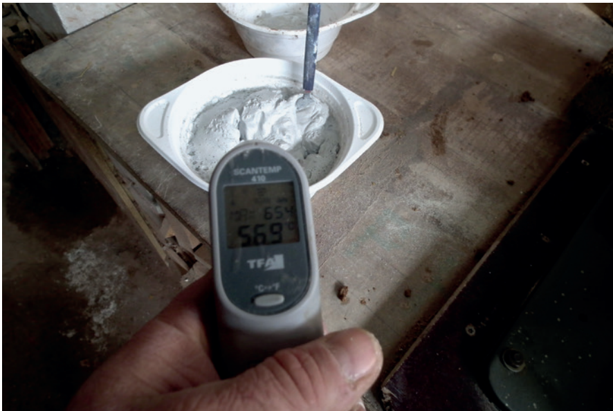
Abb. 4: Temperaturmessung bei einer Probemenge von 200 g: bis 65° C.
